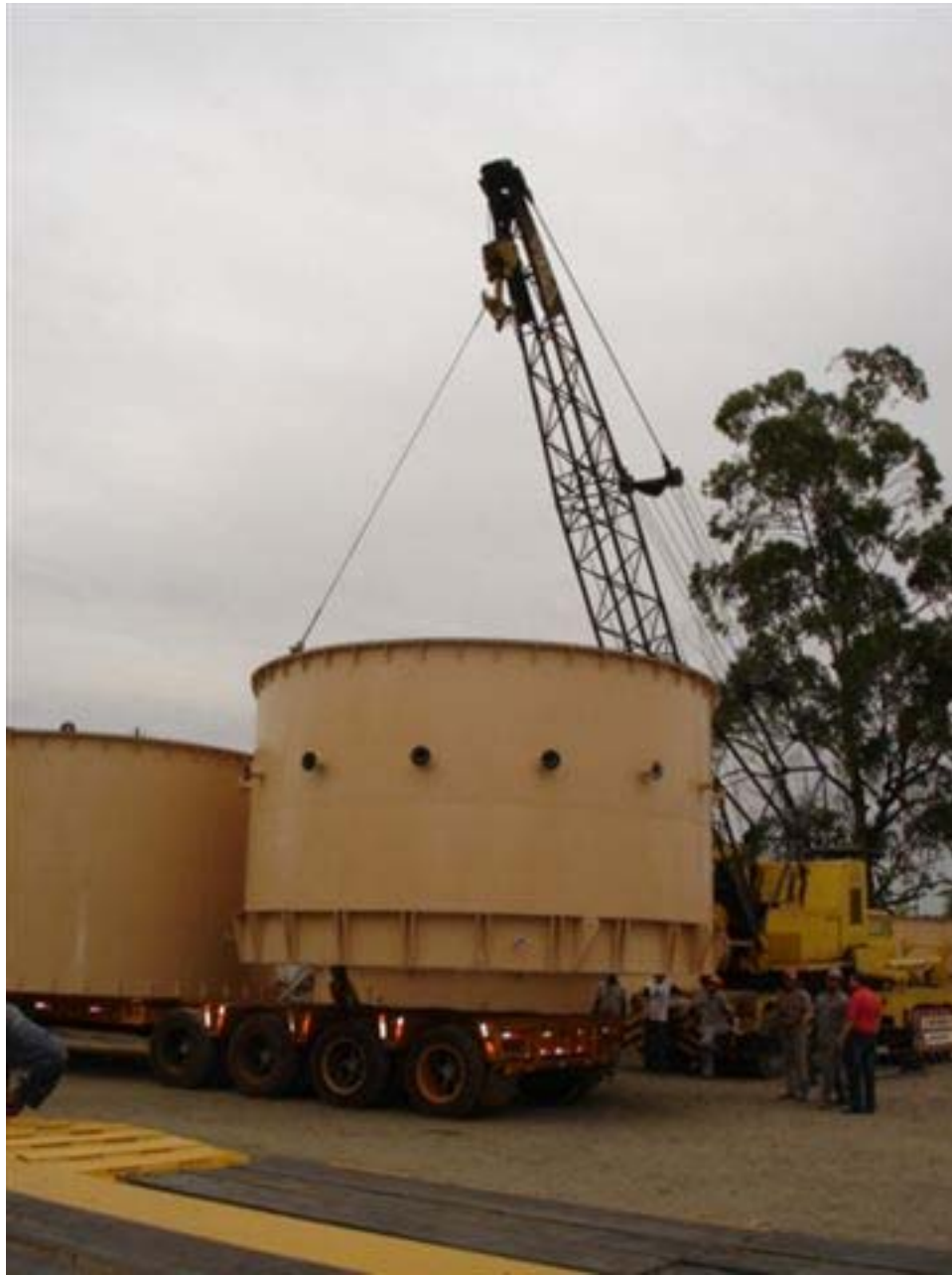
装载中的 CPT 浮选柱，可看见连接 CT 管气体分散系统的连接口
