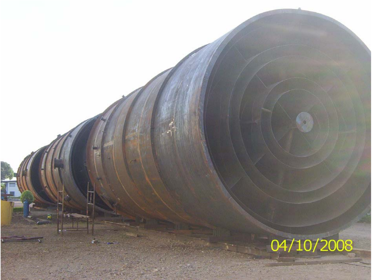
分段的 CPT 公司 6 米直径、14 米高的浮选柱
